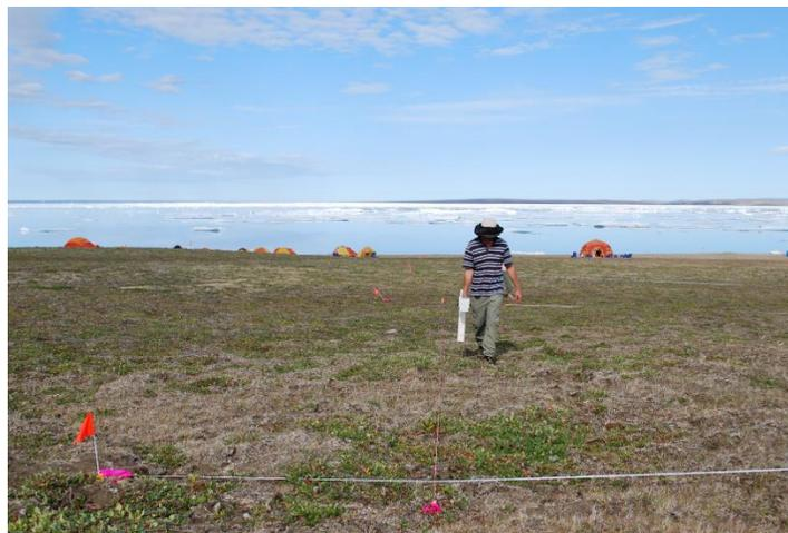
**Figure 1.** Levé magnétométrique de trois sépultures européennes non-marquées à Mercy Bay, TNO. L'instrument utilisé est un gradiomètre par flux Geoscan FM256.
